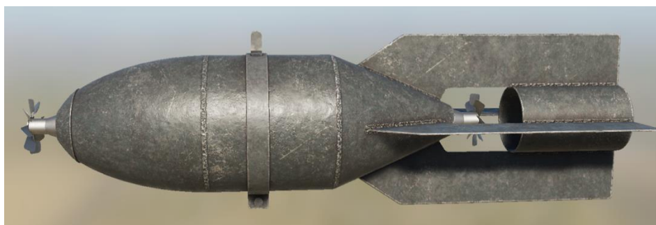
Рисунок 32: Общий вид авиабомбы ФАБ-100св
