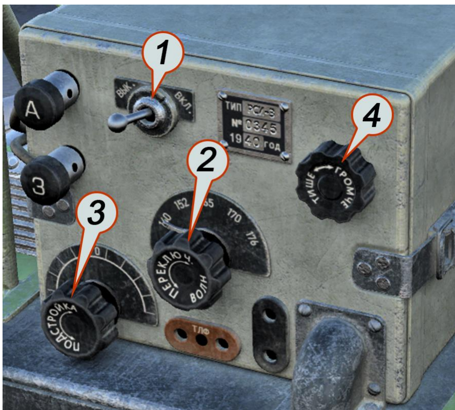
Рисунок 57: Панель управления приемника РСИ-3
