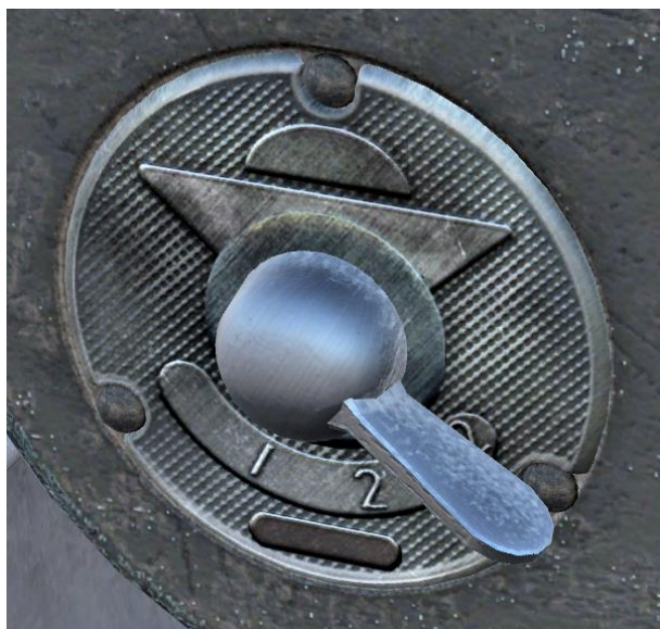
Рисунок 44: Общий вид переключателя магнето ЭС-9
