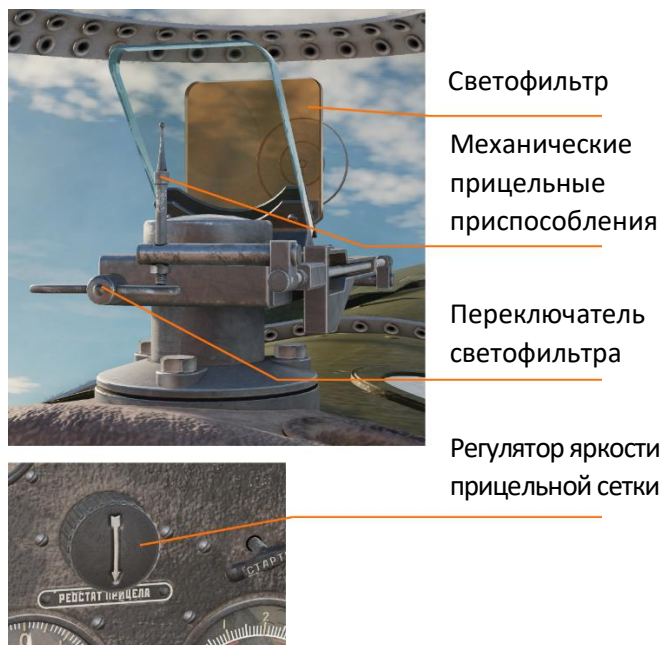
Рисунок 76: Основные функциональные элементы прицела ПАК-1
